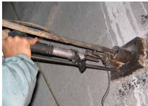
写真-1 打撃装置を用いた調査状況
