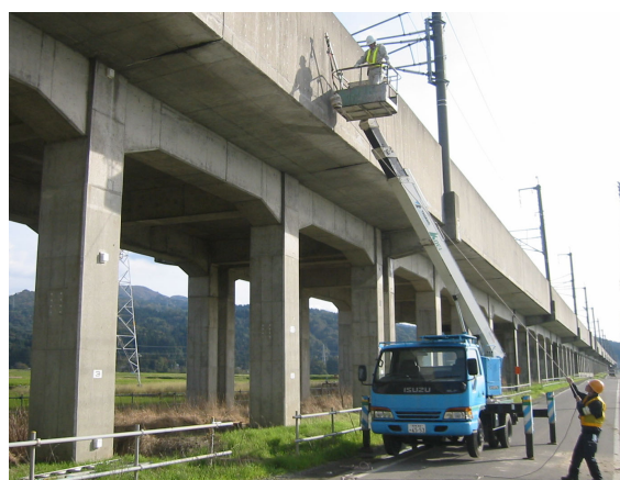
図-2 衝撃振動試験 実施状況図
