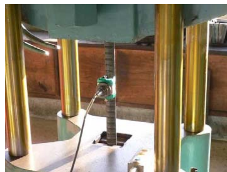
写真1 応力測定状況
