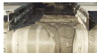
図6 微細砂脱水状況
