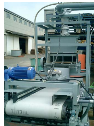
図3 微細砂回収装置
