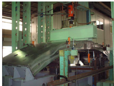
写真-3 単体曲げ試験状況
