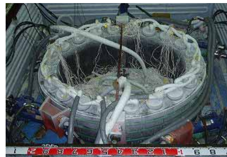
写真1 複合リング実験状況
