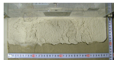
図-5 地山安定材の充填状況
