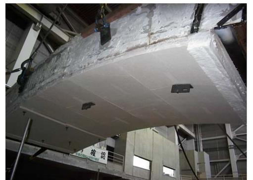
写真-2 加熱後試験体（本体部）
