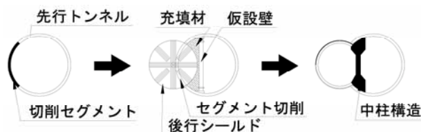
図-2 分岐合流部（中柱構造）の施工手順
