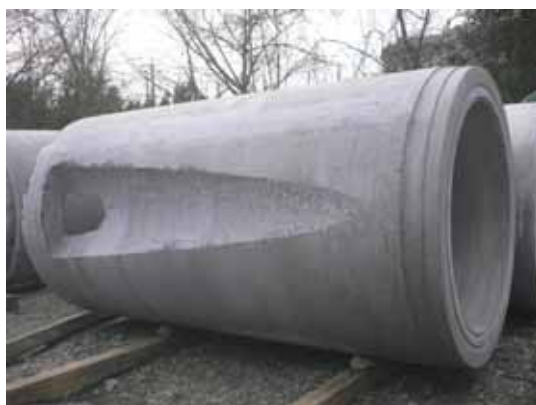
写真-2 切削試験完了状況
