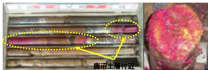
写真-1 ボーリングコア(フェノールフタレイン反応後)
