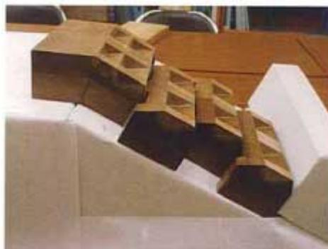
写真-1 試作段階の護岸ブロック模型
