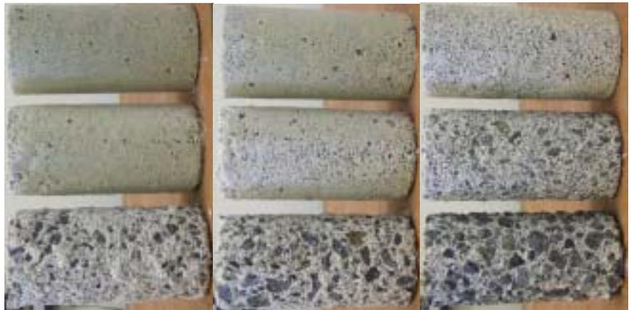
写真2 コンクリート供試体の経時劣化
