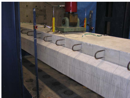
写真-1 単体曲げ試験装置
