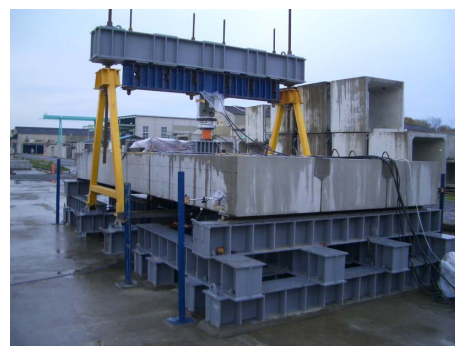
写真-2 3枚一体曲げ試験装置
