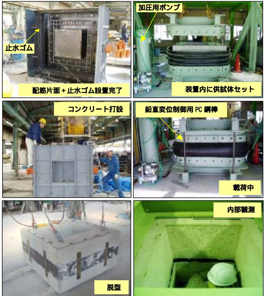
写真-1 供試体の製作方法
