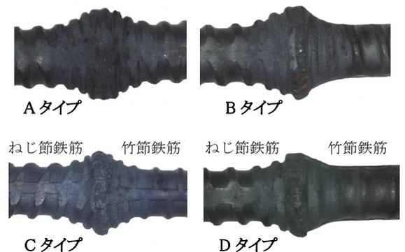
写真-1 試験片の種類
