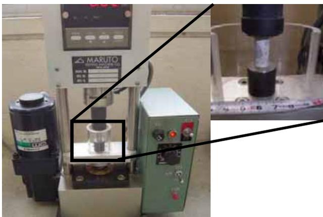
写真1 携帯型強度試験機
