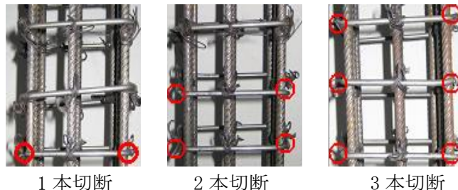
図 2 帯鉄筋の切断状況
