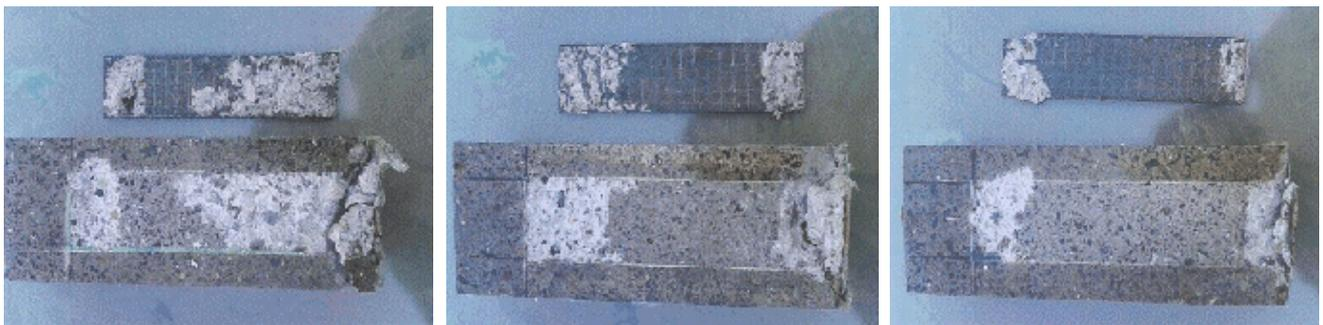
(a) 23kN クリープ試験剥離後 (b) 16.8kN クリープ試験剥離後 (c) 14kN クリープ試験剥離後
