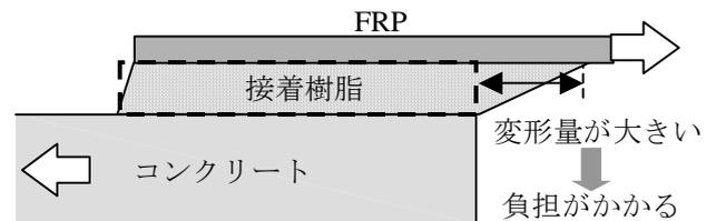
図-2 FRP-コンクリート接着界面
