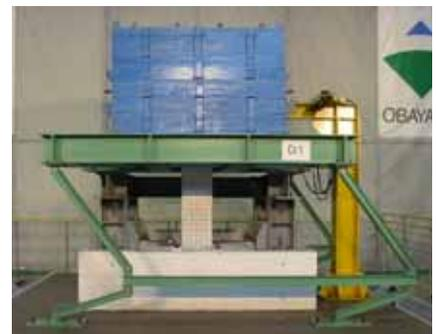
写真-1 試験体と加振装置
