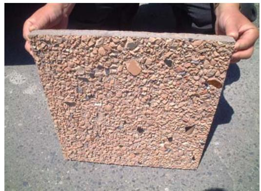
写真-1 KCクリート（洗い出し処理）
