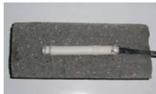
図-1 埋込型ひずみ計の設置
