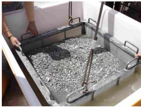
図-1 再生骨材のシリカ質溶液への浸漬作業
