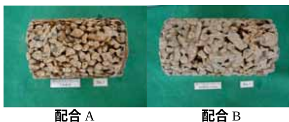
写真1 材齢10年ポ-ラスコンクリート強度試験体の外観
