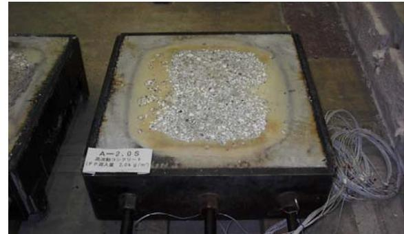
写真-2 加熱後の実験体の様子 (A-2.0S)
