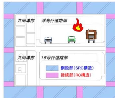
図-1 MMST 構造断面図
