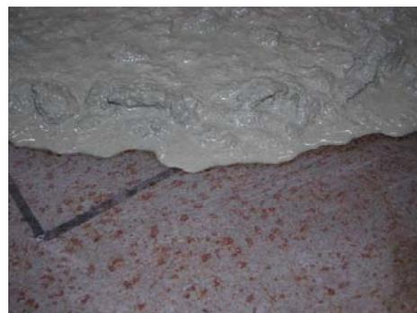
写真-1 スランブフロー（高流動：繊維量 2.0kg/m<sup>3</sup>）
