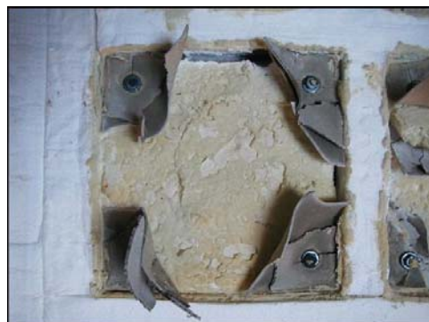
写真-3 無機系耐火パネル（基板厚8mm）
