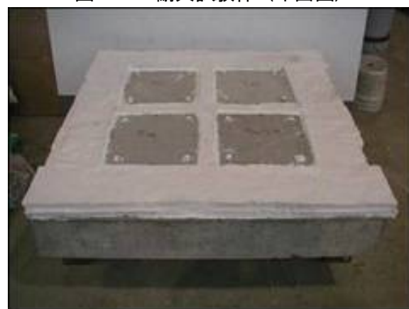
写真-1 耐火試験体（無機系）
