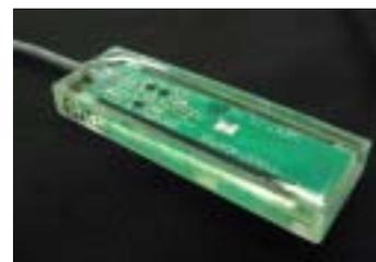
図-2 使用した RFID タグ
