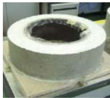
図1 乾燥収縮ひび割れ供試体
