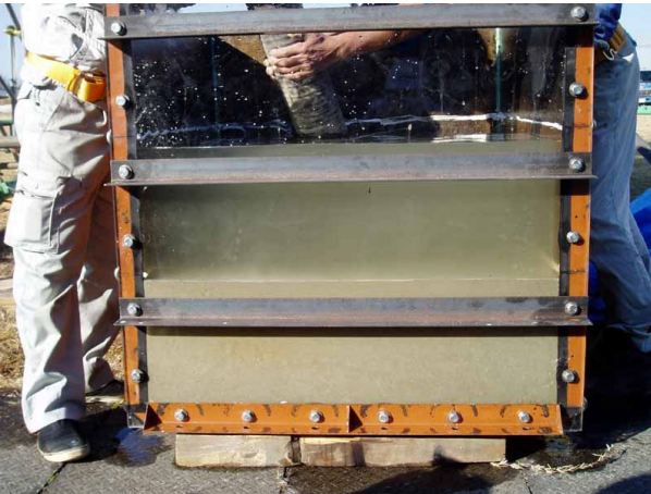
写真－1 水中打ち込み実験状況
