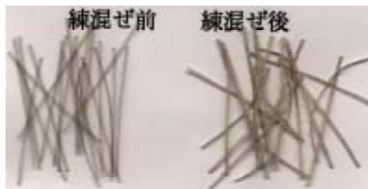
写真-2 PE&amp;PP繊維の練混ぜ前後の表面性状
