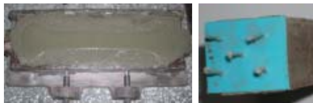
写真-4 繊維の呼着試験用供試体
