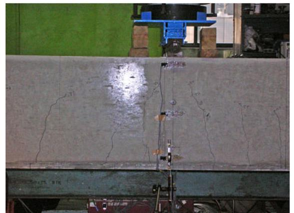
図-5 最大荷重時の試験体状況
