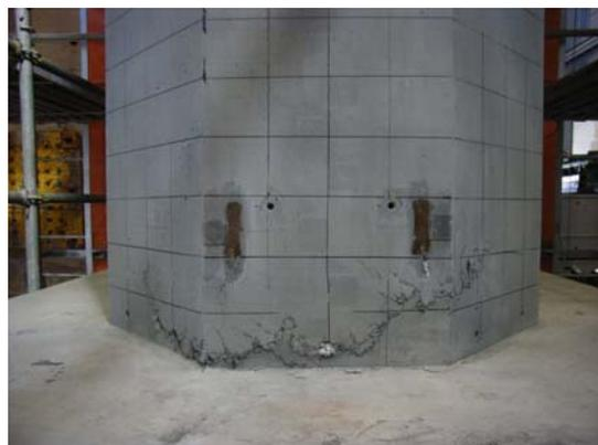
写真 破壊状況(基部圧縮縁)
