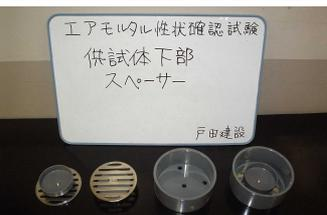
写真-1 供試体の下面排水構造
