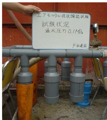
写真-2 透水装置の概要
