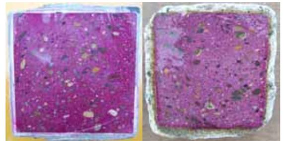
写真-1 チタンシート部 モルタル露出部 酸による侵食状況(6ヵ月後)
