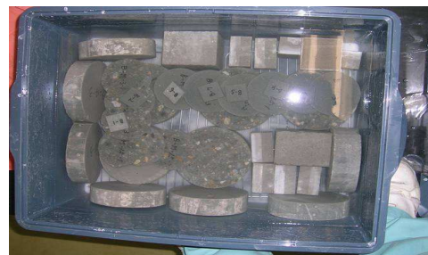
写真-1 BAC池モデルの浸漬状況
