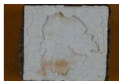
写真2 W/C65%-0.3%硫酸で乾燥ありの場合の供試体表面
