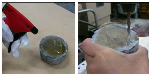
写真-1 硝酸銀溶液噴霧・ドリル削孔状況
