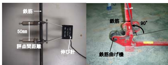
図 1 応力負荷方法(左:引張,右:曲げ)
