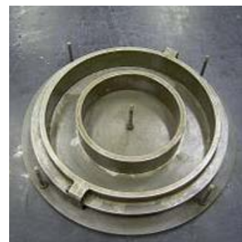
写真-1 リング型拘束応力試験用型枠
