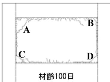
図-6 ひび割れ性状(解析結果)
