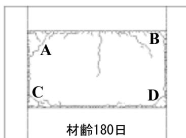
図-7 ひび割れ性状(解析結果)
