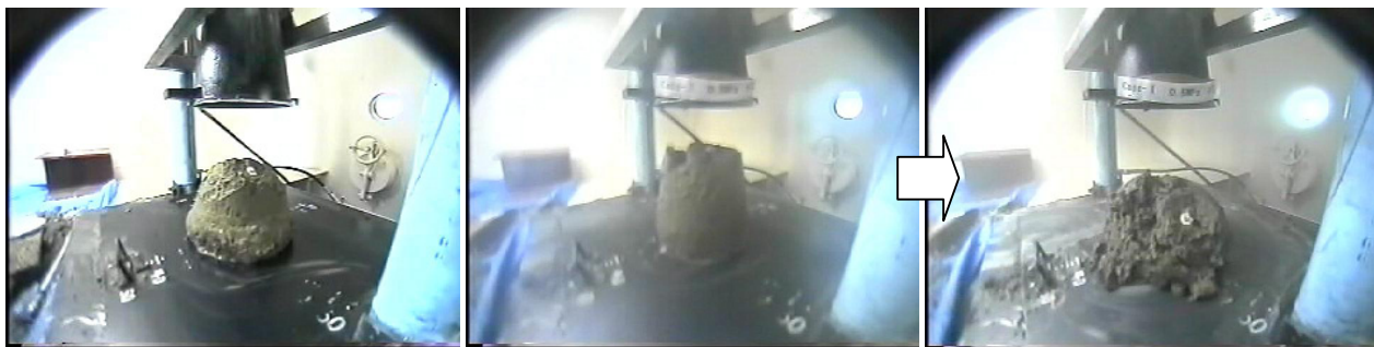
a) 大気圧下(0MPa)：スランプ 15cm b) 高気圧下(0.5MPa)：スランプ 11cm c) 減圧完了時(0MPa)：崩壊
