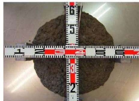
写真-1 スランプフロー試験結果
