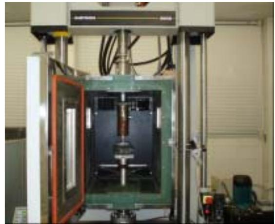
写真-1 動的載荷試験機
