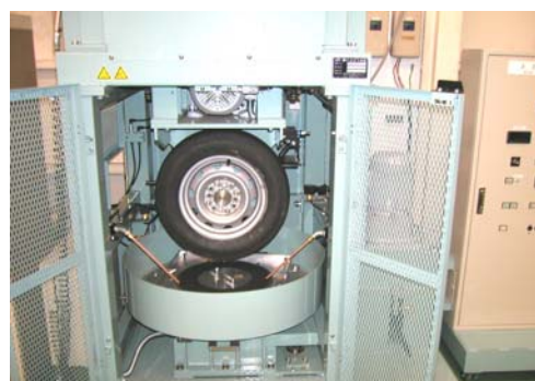
図 1 促進磨耗試験機
