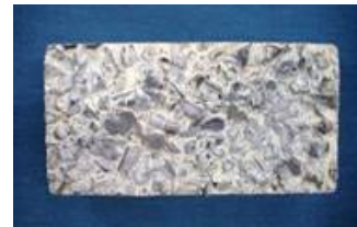
写真1 NO x 除去ブロック
