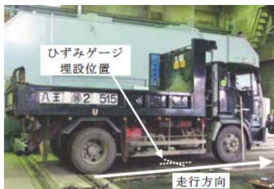
写真 1 走行試験の状況
