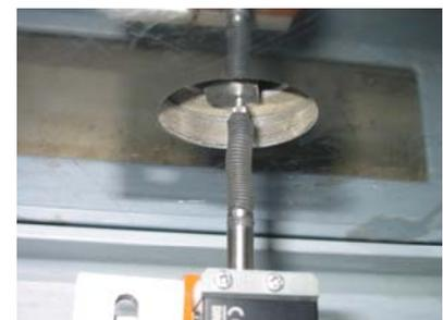
写真-2 ナットと変位計の接触状況
