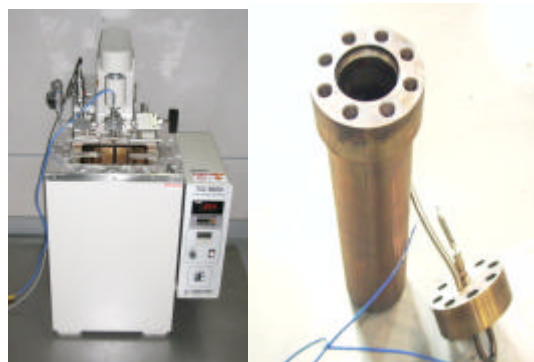
図-1 超臨界用試験装置
