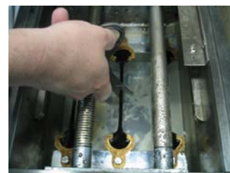
写真-2 供試体切断状況
