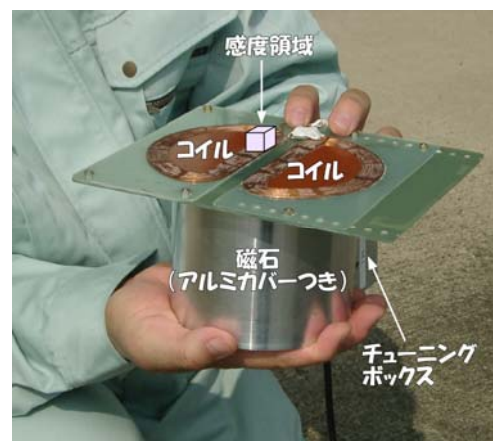
図2 NMR 表面スキャナーシステムのセンサー部分(磁石とコイルからなる)。センサーの感度領域の概形を立方体(1.5 cm 3 )で図示。
